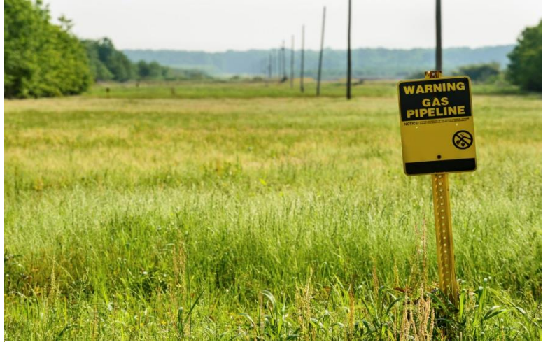
Panneau indiquant la présence d'un pipeline souterrain
