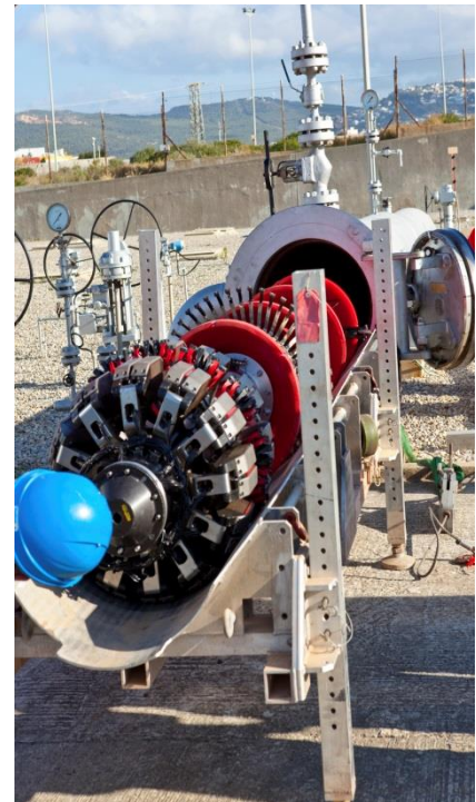
Racleur intelligent (outil de détection des fuites de flux magnétique et diamètre)
